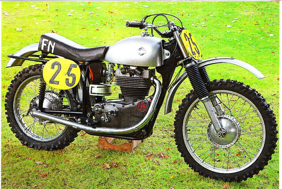
**Neuer Rahmen, Magnesiummotor:** Die M 15-Generation ab 1952 (hier ein 1956er Exemplar) folgte gängigen Baumustern. Die Gabel stammt von Norton, das Werk experimentierte aber auch mit anderen Marken, zum Beispiel NSU
