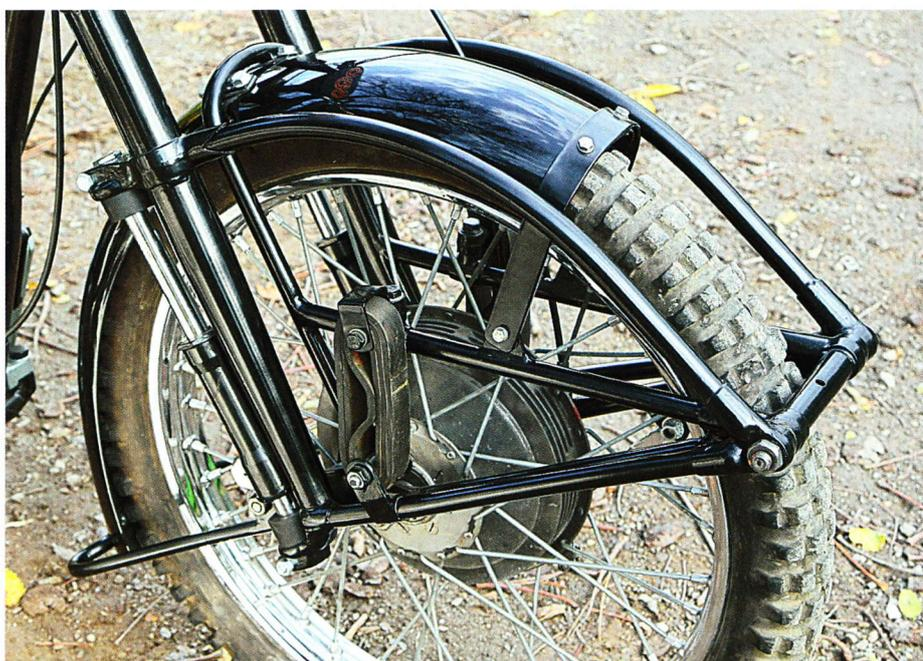
Die Geradwegführung hinter dem Gabelkörper dient der exakten Radführung. Die Gummischläge begrenzen zudem die Federwege. Das Schutzblech ist an der Dreieckschwinge befestigt und macht die Federbewegungen mit
