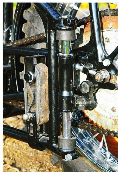
Auch am Hinterrad finden sich die Geradwegführungen. Ein kurzes Gelenkstück verbindet sie mit der Schwinge
