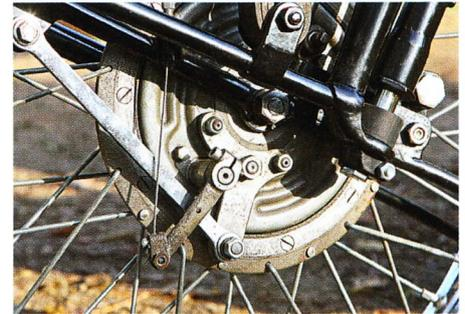
Leichtbau auf belgisch: Magnesiumnabe, kombiniert mit gusseiserner Ankerplatte aus dem Automobilbau
