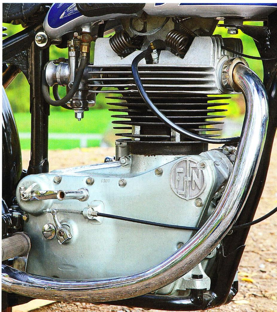
Bei den frühen Versionen steht der Amal-Vergaser waagrecht, ab 1950 wurde der Ansaugstutzen nach oben angewinkelt
